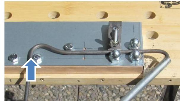
Preparar la dobladura cuarta, colocando la varilla con su parte izquierda a la cabeza del tornillo de la derecha (véase flecha) y fijar con la tuerca de mariposa
