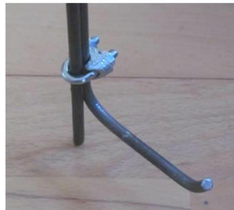
Abrazaderas pueden servir para fijar las tres patas del trípode, si un equipo de soldadura no está disponible.
